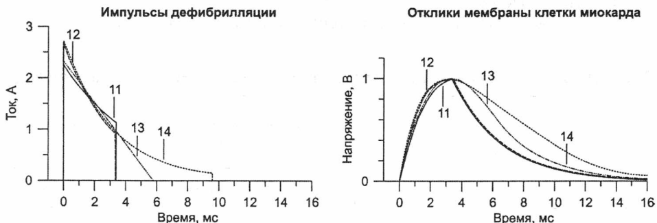
Рис. 6. Группа импульсов низкой эффективности: 11 – трапецидальная форма импульса со спадом до 0,5; 12 – трапецидальная форма импульса со спадом до 0,35; 13 – треугольная спадающая форма импульса; 14 – экспоненциальная форма импульса со спадом до 0,05
