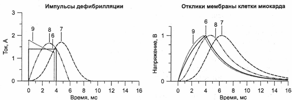
Рис. 5. Группа импульсов средней эффективности: 6 – прямоугольная форма импульса; 7 – колоколообразная форма импульса; 8 – полусинусоидальная форма импульса; 9 – трапецидальная форма импульса со спадом до 0,7
