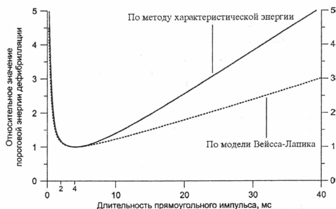
Рис. 3. Графики относительных значений пороговой энергии монополярного прямоугольного импульса дефибрилляции в зависимости от длительности импульса, полученные по методу характеристической энергии и по модели Вейсса-Лапика
