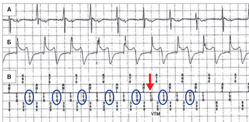
Рисунок 4. Фрагмент эндограммы из ИКД во время Т-зубцового оверсенсинга. А – предсердный канал; Б – желудочковый канал; В – маркерный канал. При сопоставлении сигналов желудочкового и маркерного каналов отмечается восприятие сигнала, соответствующего Т-зубцу (отмечено овалами), в результате чего частота детектируемого ритма удваивается и происходит детекция ЖТ (отмечено стрелкой). У двух последних комплексов Т-восприятие отсутствует.
