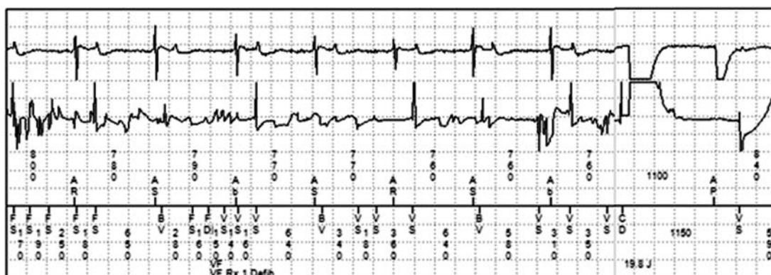
Рис. 1. После регистрации длительных эпизодов шумов на дефибрилирующем электроде имплантированный кардиовертер-дефибрилятор дискриминировал их как фибрилляцию желудочков и нанес разряд мощностью 20 Дж
