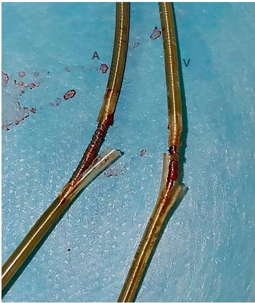
Рис. 6. Место перелома электродов. Отчетливо видны как нарушение изоляции, так и повреждение внешней спирали электродов.
