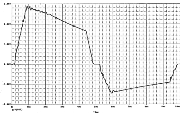
Рис. 1. Результат моделирования импульса дефибрилляции с энергией 200 Дж на нагрузке 150 Ом.
