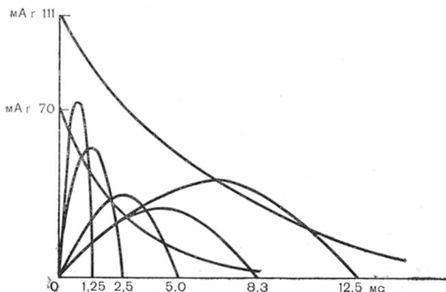
Рис. 40. Сравнительные величины дефибриллирующего тока в зависимости от продолжительности импульса и градиента его заднего фронта (по Geddes e. a., 1970).
