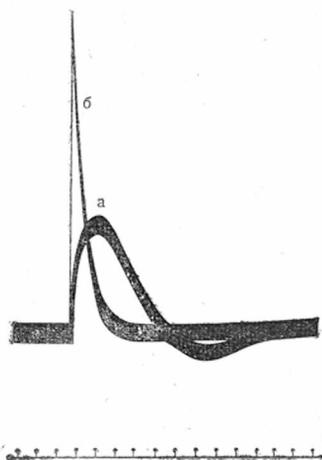
Рис. 21. Сравнительная величина амплитуды тока при дефибриляции сердца собаки разрядами различной формы.
