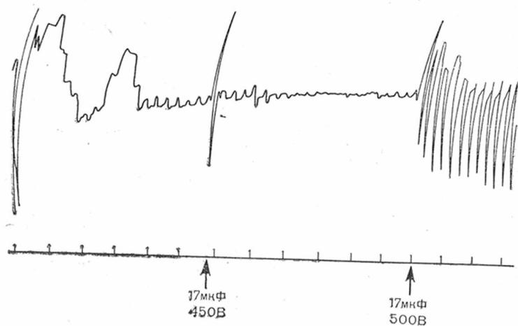
Рис. 27. Кривая сокращения желудочков. Дефибрилляция сердца щенка (масса 3,6 кг) при непосредственном приложении к нему электродов. Внизу отметка времени через 1 с. Стрелками указаны моменты разряда.
