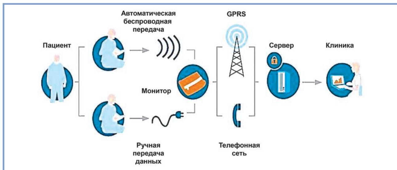
Рис. 1. Система удаленного мониторинга имплантированных устройств.
